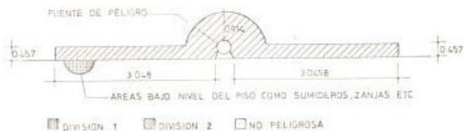
Fig 3-10 - AREAS DE BOMBAS AL AIRE LIBRE
