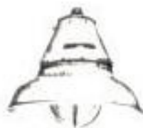
FIG. 5-17 LAMPARA INCANDESCENTE, CLASE I, DIV 1, GRUPOS C y D
