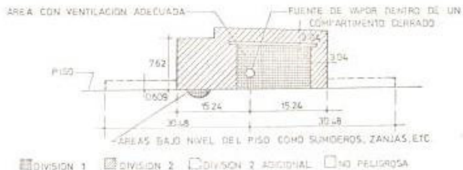
Fig 3-6 - AREA DE PROCESAMIENTO CON VENTILACION INADECUADA
