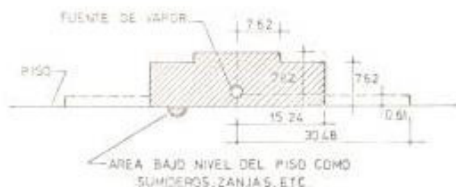
Fig 3-4 - AREA DE PROCESO VENTILADA ADECUADAMENTE (FUENTE DE PELIGRO SITUADA CERCA AL PISO)
