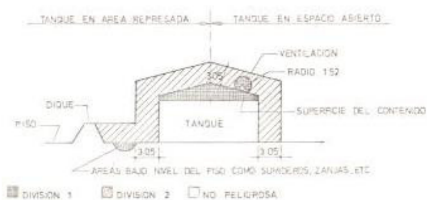
Fig 3-7 - TANQUE DE REFINERIA
