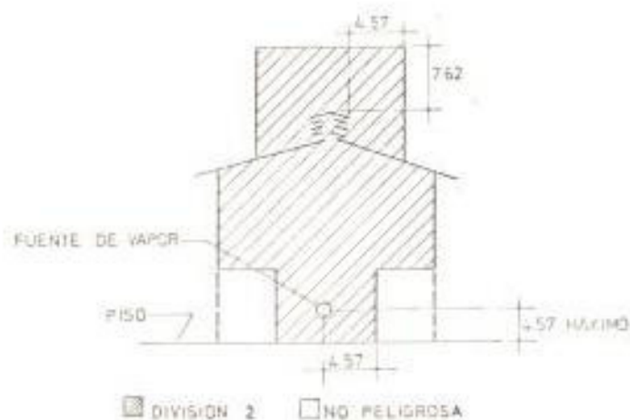
Fig 3-8 - CUARTO DE COMPRESOR CON VENTILACION ADECUADA PARA UN VAPOR MAS LIVIANO QUE EL AIRE
