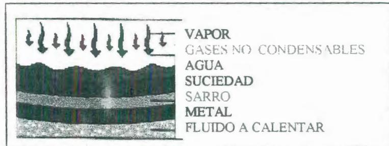
Fig. # 47 – Posibles reductores de la transferencia de calor y la temperatura del vapor que deben ser superados para poder obtener vapor vivo.
