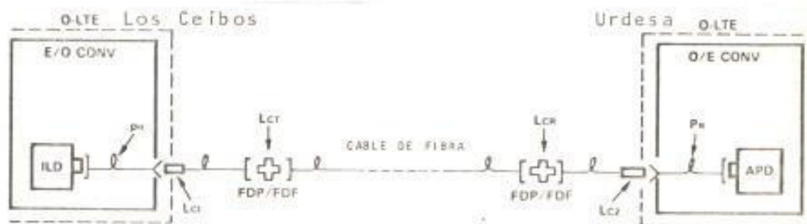
FIGURA 4.1 DEFINICIÓN DE LAS PERDIDAS EN EL SISTEMA
