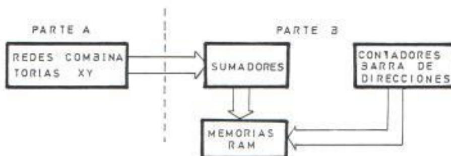
FIGURA 9.- DIAGRAMA DE BLOQUE DEL GENERADOR DE DIRECCIONES.
