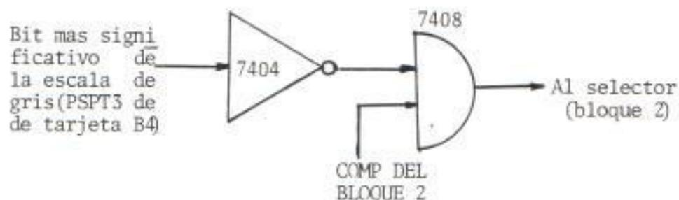
FIGURA Nº13 .-DIAGRAMA DE BLOQUE DEL CONTROLADOR DE LUMINOSIDAD DEL CURSOR
