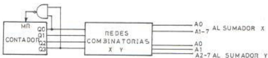
FIGURA Nº 10.- DIAGRAMA DE BLOQUE DE LA PARTE A DEL GENERADOR DE DIRECCIONES
