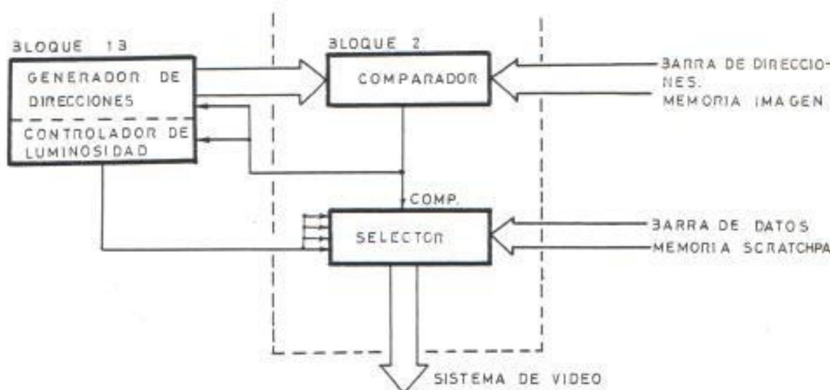
FIGURA N° 14.- DIAGRAMA DE BLOQUE DEL COMPARADOR - SELECTOR.-
