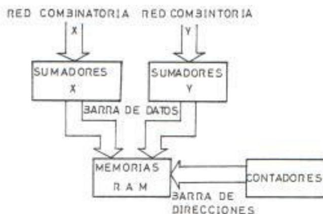
FIGURA Nº 11.-DIAGRAMA DE BLOQUE DE LA PARTE B DEL GENERADOR DE DIRECCIONES.
