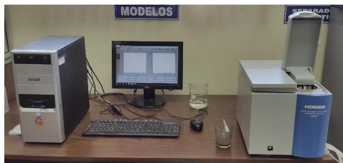
**Figura 2.6:** Analizador de partículas por difracción laser HORIBA LA-300
