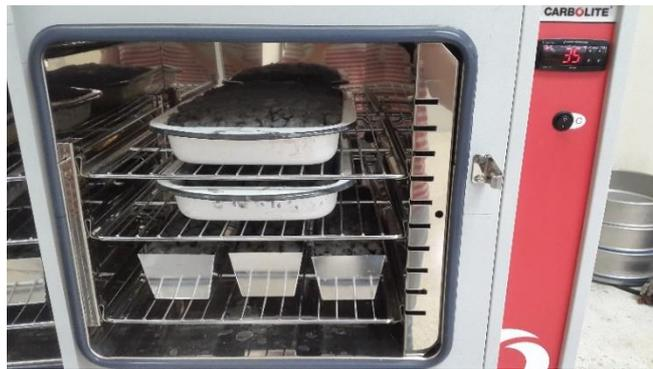
**Figura 2.4:** Horno de secado Carbolite serie AX.
