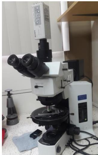
**Figura 2.7:** Microscopio minerográfico marca Olympus BX51
