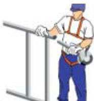
2.- Colocar las barras horizontales insertando las garras en el tubo vertical de los laterales
