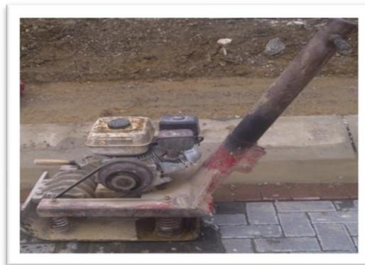
**Figura 2.6 Compactadora a diesel**
