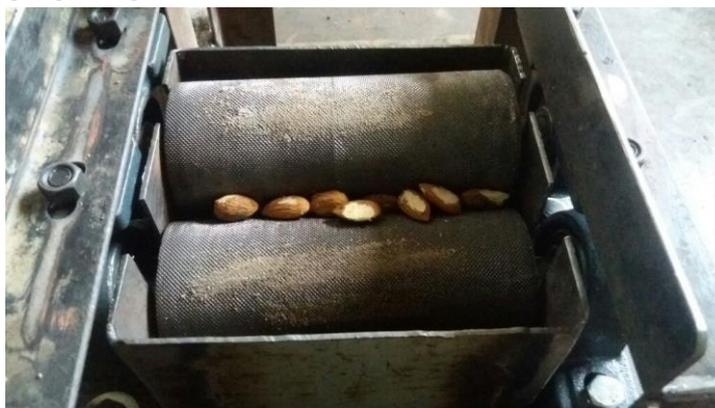
**Figura 7.1. Prototipo, sección de pelado**
