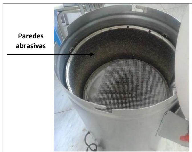
**Figura 1.14. Esquema de una cámara con paredes abrasivas.**
