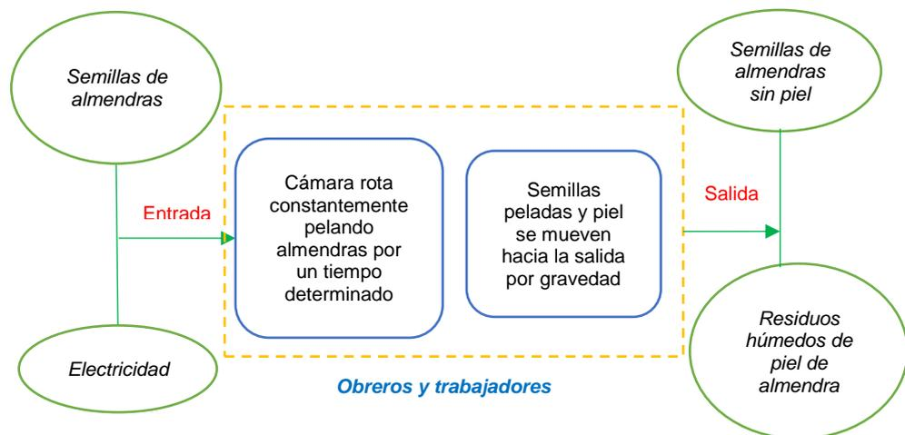
**Figura 1.13. Diagrama de pelado con cámara de paredes abrasivas.**
