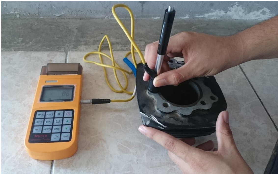
Figura 3.3 Ensayo de dureza en bloque original
