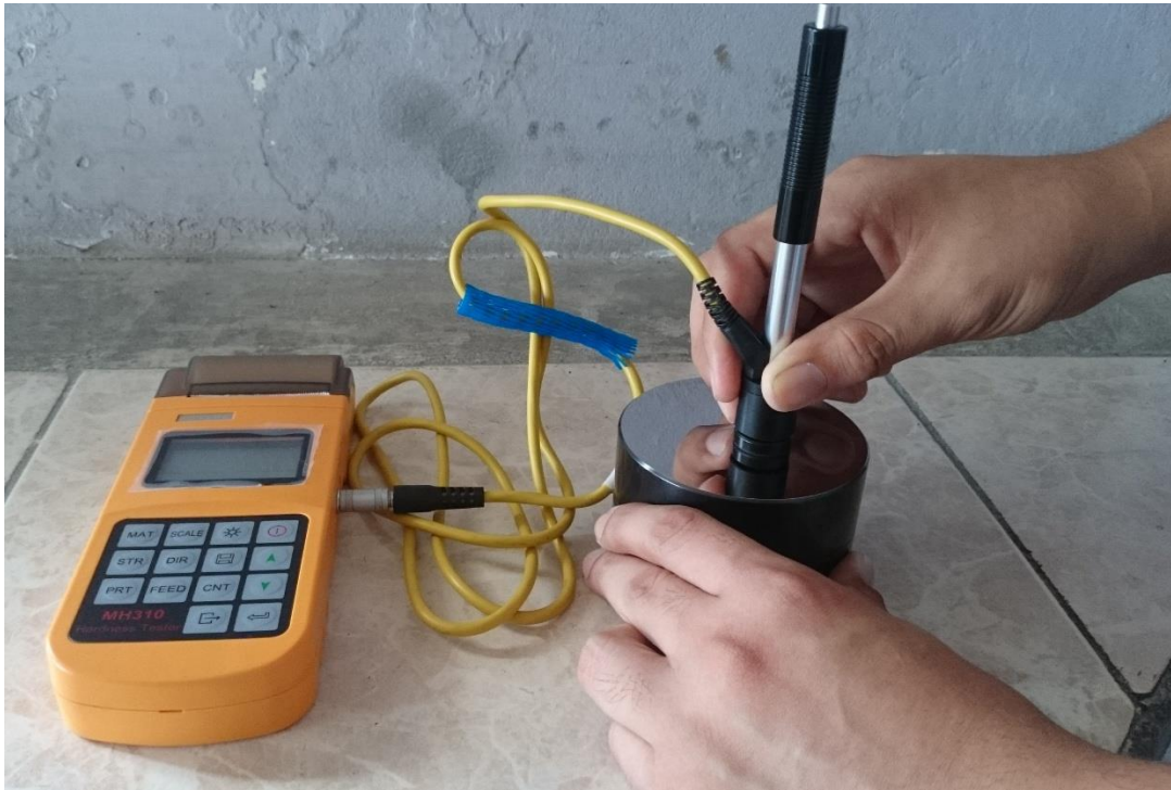
Figura 3.2 Calibración del durómetro Leeb Hardness Tester MH310
