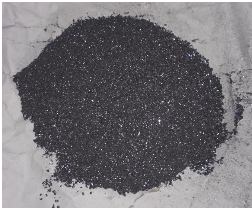
Figura 3.16 Silicio triturado, tamiz 3 mm
