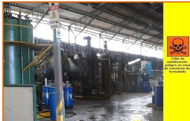
**Figura 4.5 Zona De Reactores Sin Señal De Peligro**
