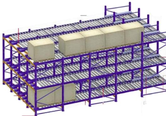
**Figura 2.6: Sistema de almacenamiento dinámico.**
