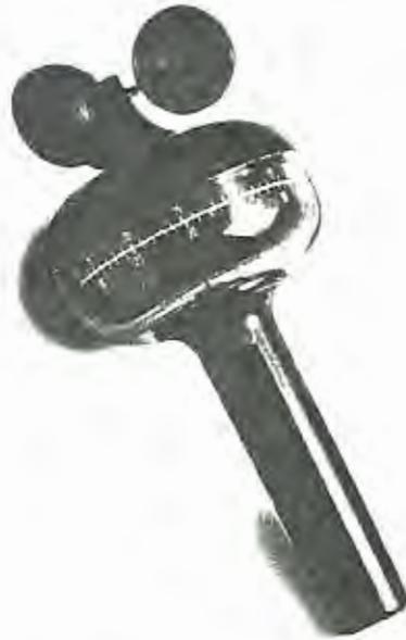
**Figura 1.5. Anemómetro de cazoletas portátil**
