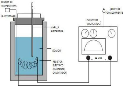
A través de la potencia eléctrica suministrada por medio de una fuente de voltaje continua, se logra que la potencia térmica disipada por un resistor eléctrico, sumergido en el líquido dentro de la cámara del calorímetro, logre incrementar su temperatura.
