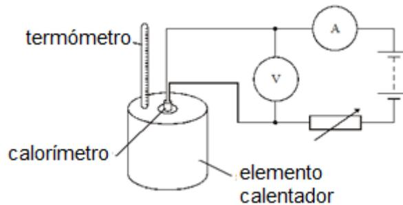
El líquido es calentado y manteniendo la Potencia Eléctrica controlada del elemento calentador en 80 W, se toman lecturas de las variaciones de temperatura registradas cada 120 segundos. Se presenta la siguiente tabla:
