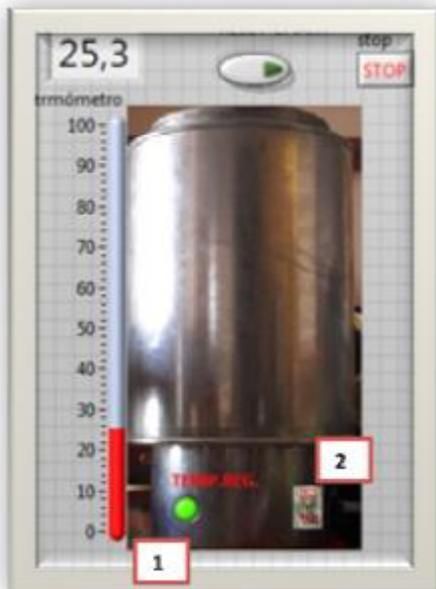
1. **Indicador de Calentamiento:** Permanece iluminado mientras el prototipo se encuentra en proceso de calentamiento
