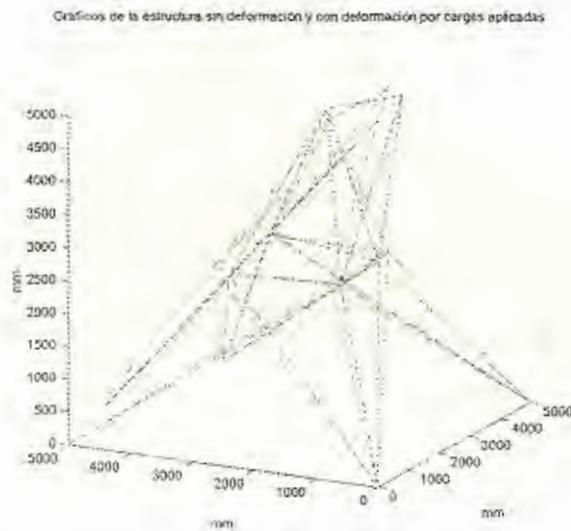
Fig. 4.10 Deformaciones estáticas de estructura tipo pórtico
