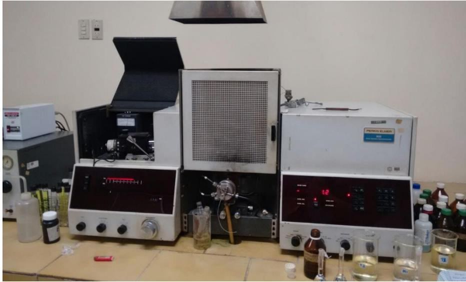
**Figura 3.9** Espectrofotómetro de absorción atómica Perkin Elmer 603.
