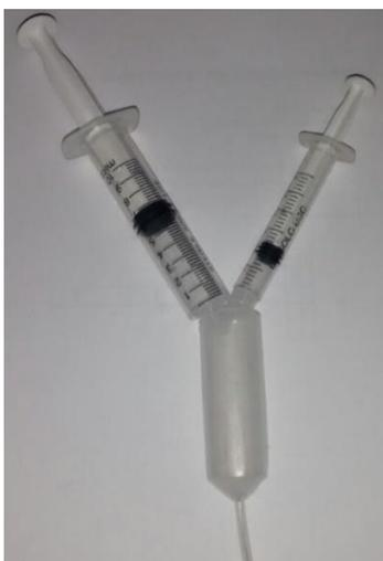
**Figura 3.5** Sistema de generación y aplicación del ácido de caro a escala laboratorio.
