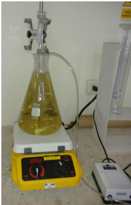
**Figura 4.1** Aplicación del método de tratamiento con ácido de caro.
