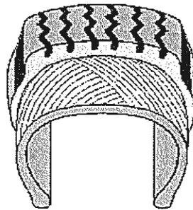
Fig. 1.1 Neumático Diagonal
