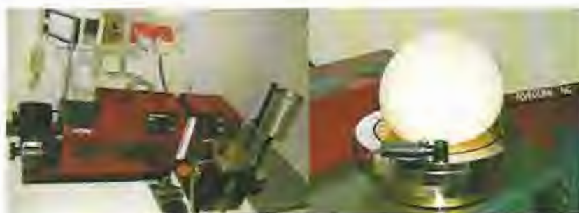
Figura 2.4 Masa insuflada durante el análisis con el Alveógrafo de Chopin
