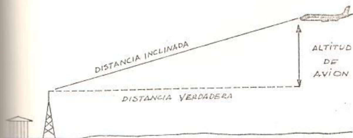
Figura 2-26 ILUSTRACION DE DISTANCIA INCLINADA Y3 DISTANCIA VERDADERA
