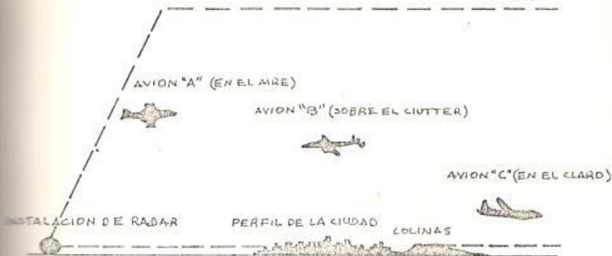
Figura 2-19 VISTA DE PERFIL INDICANDO BLANCOS TÍPICOS DE RADAR.
