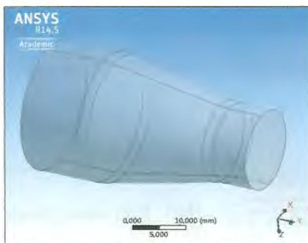
**FIGURA 3.3 GEOMETRÍA DEL VOLUMEN DEL FLUIDO QUE ATRAVIESA EL MEDIDOR TUBO VENTURÍ EN ANSYS-CFX 14.5**
