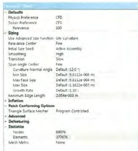
**FIGURA 3.7 DETALLE DEL MALLADO DEL VENTURI**
