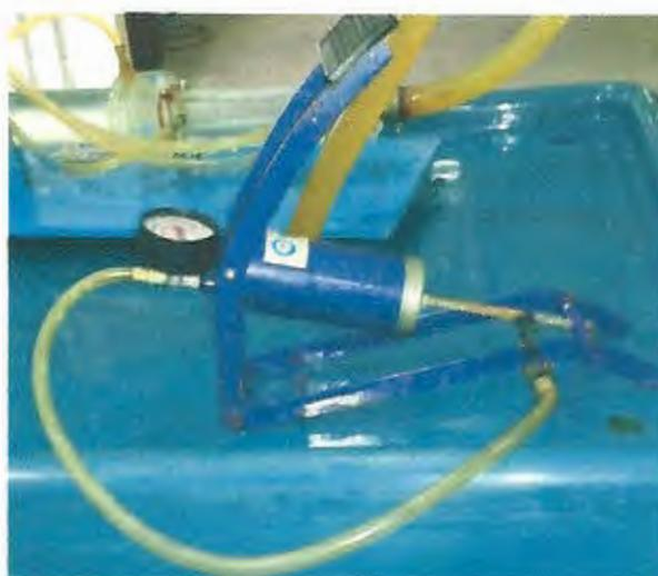
**FIGURA 4.8 BOMBA DE AIRE MANUAL**
