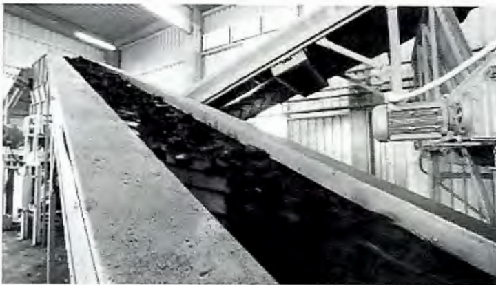
Figura 2. 27. Cinta con nervios en la industria del reciclaje de NFU. [42]
