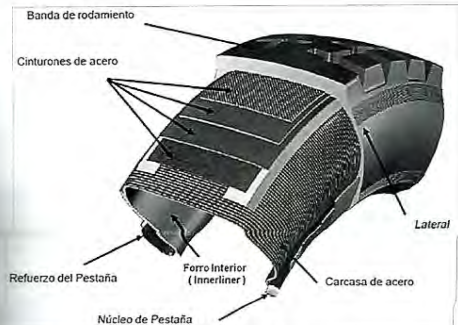
Figura 1. 1. Estructura de un neumático de camión radial. [3]
