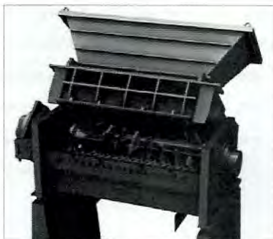
Figura 2. 15. Perspectiva de las cuchillas del triturador marca ELDAN, montadas en un solo eje.[41].
