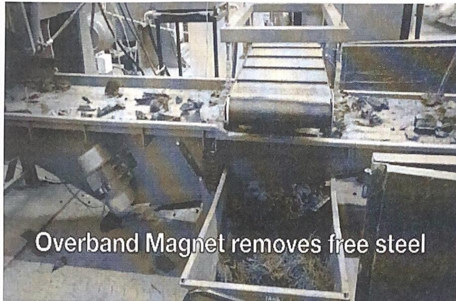
Figura 2. 9. Banda magnética para separación de metales. [41]
