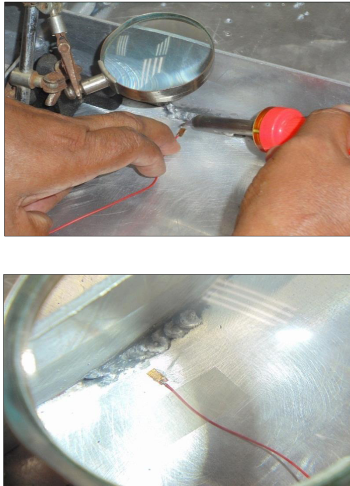
Figura E 2: Soldadura de los terminales de los extensómetros a los cables conductores.
