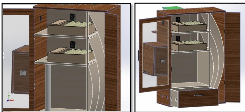
Figura 2.10: muestra el sistema de volteo con capacidad de incubación de 40 huevos.
