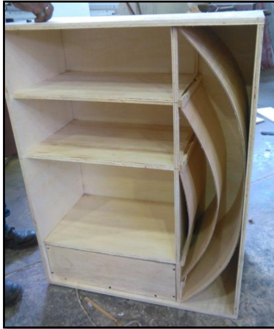
Figura 2.16: Muestra los canales de flujo de aire dentro de la incubadora.
