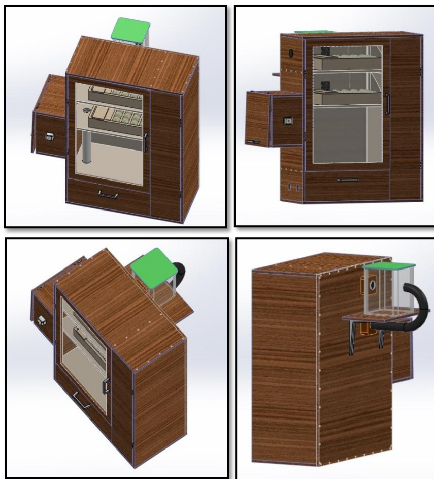
Figura 2.6: Incubadora con los diferentes sistemas incorporados para el proceso de incubación artificial.
