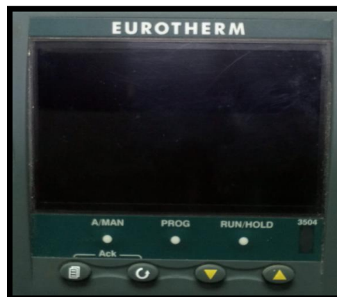
Figura 3.6: Controlador Eurotherm 3504 vista frontal [18]
