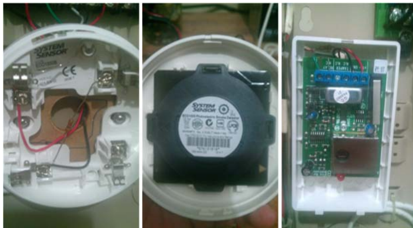
Figura 3.2: Vista interna de los detectores de humo y de movimiento.
