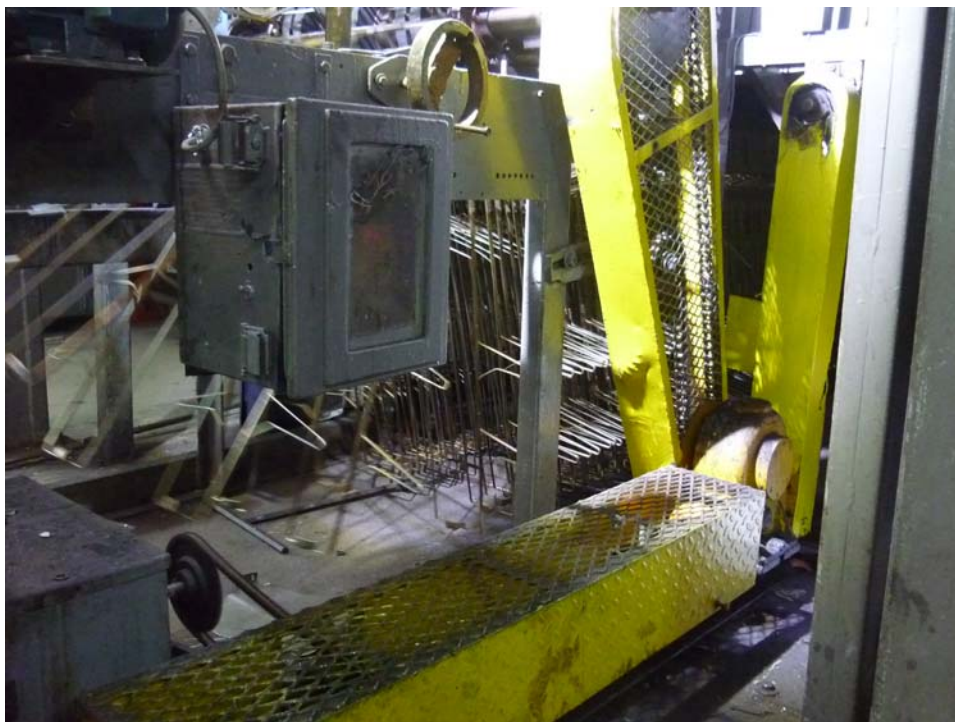
Foto 2. 7 Transmisión mecánica de parrillas del horno
