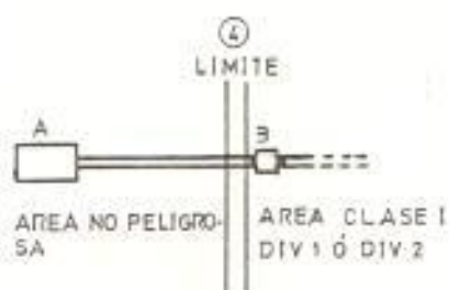
A: TABLERO POZO DE REVISION B: SELLO A PRUEBA DE EXPLOSION
