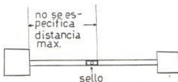
FIGURA 5.10.- SELLO ENTRE DOS CAJAS DE USO GENERAL
