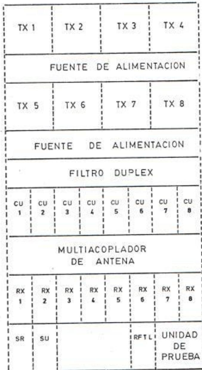
Fig. N° 25 BASTIDOR DE OCHO CANALES
