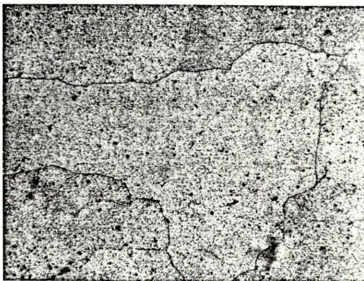
Figura 5-34. - Microestructura de una probeta extruída y enfriada al agua; posteriormente envejecida a 160°C durante 2 horas
