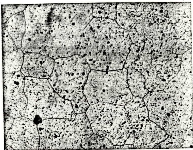
Figura 5-31. - Microestructura de una probeta extruída y enfriada al agua; posteriormente solubilizada a 570^{\circ}\text{C} durante 1 hora y enfriada al agua; envejecida a 160^{\circ}\text{C} durante 2 horas
