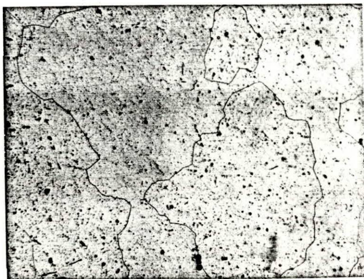
Figura 5-29.- Microestructura de una probeta extruída y enfriada al agua
