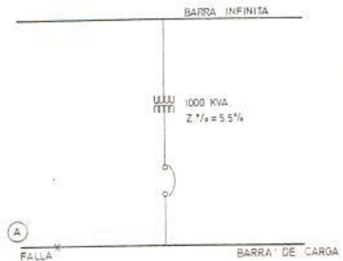
En caso de producirse una falla en el punto A, la corriente de cortocircuito estará solamente limitada por la impedancia del transformador y de la línea, la cual consideraremos despreciable.
