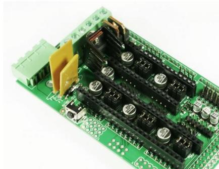
Figura 2.6. Tarjeta Modular RAMPS
