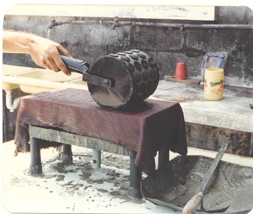
FIG. 18.- COMPACTADO DEL MORTERO
