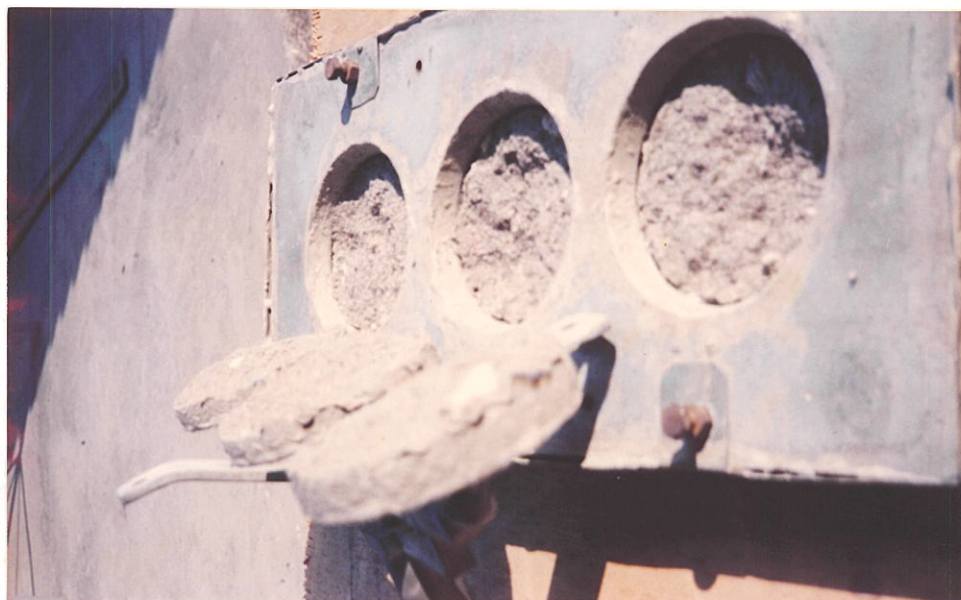
FIG. 60.- FALLA INTERNA, MORTERO-PIEDRA POMEZ
