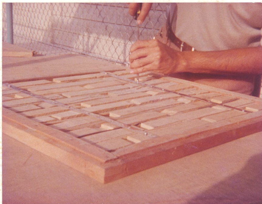
FIGURA 3.- ACOPLA CON HOJALATA Y TORNILLOS.
