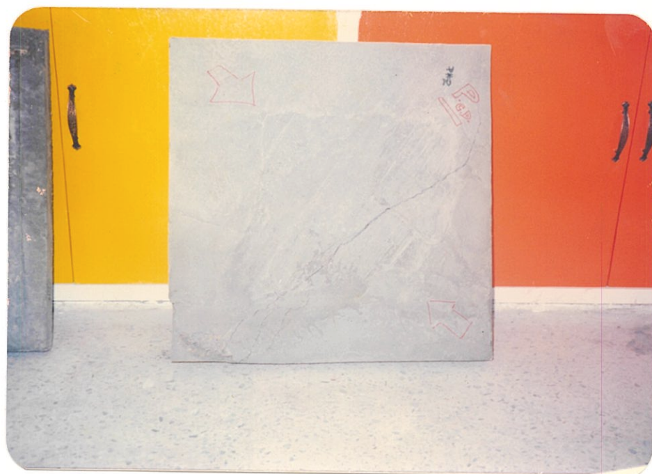
FIG. 64.- ENSANCHAMIENTO DE LA FISURA DIAGONAL
