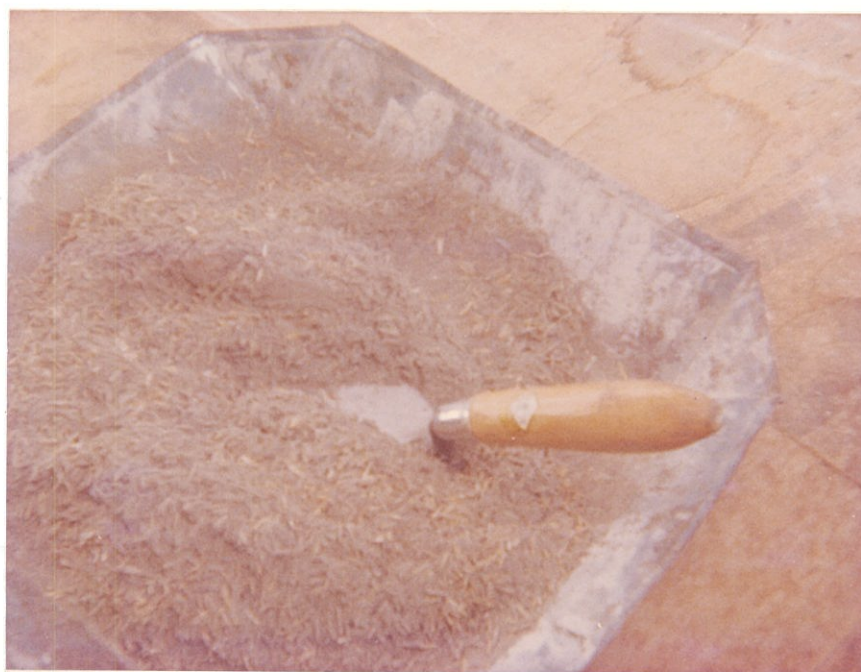
FIG. 30.- MORTERO-CASCARILLA DE ARROZ
