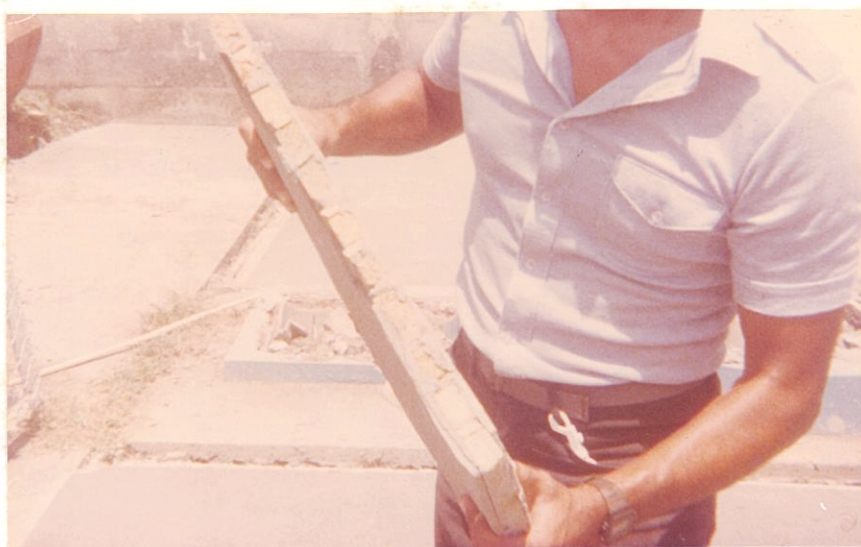
FIGURA 5.- PANEL CON ACOPLES, RECUBIERTO Y NO FRAC- TURADO.
