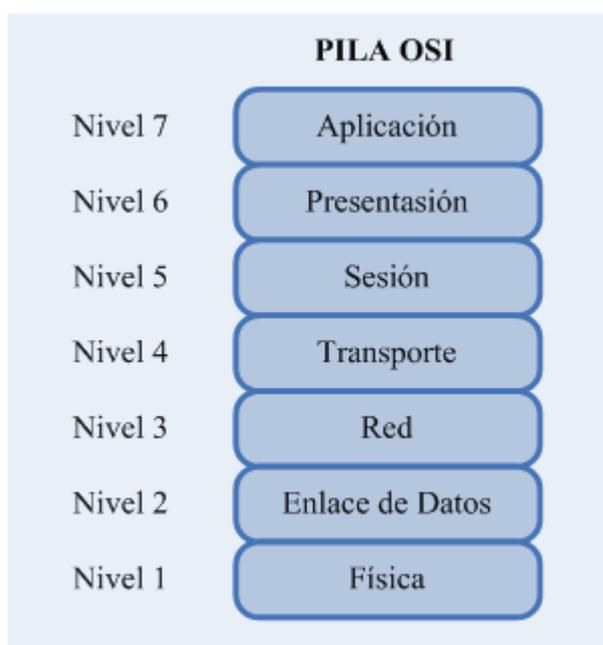
**Figura 1.6** Pila de capas del modelos OSI.
