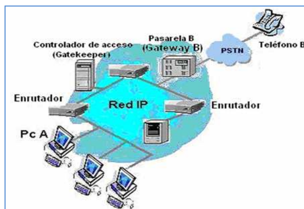
Figura 1.7 Esquema: Llamada PC a Teléfono.
