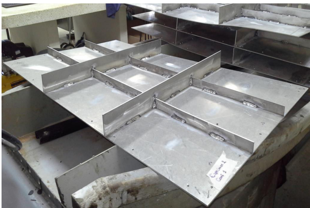
FIGURA 16. Construcción de un panel reforzado.
