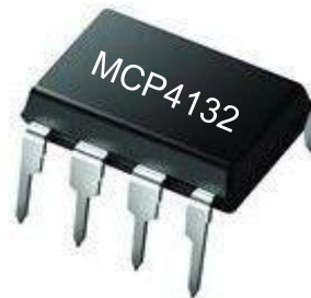
Figura 2-7 Potenciómetro Digital MCP4132 [9]
