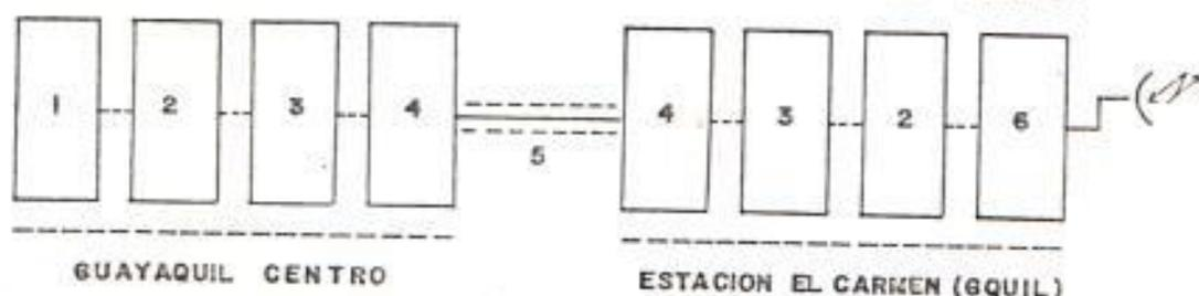
Fig. 5.2 Diagrama de bloques del sistema usando fibra óptica.
