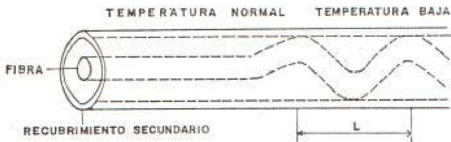
Fig. 4.6 Micro curvaturas en la fibra óptica
