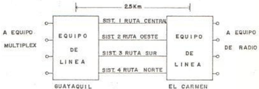
Fig. 1.5 Diagrama de bloques del enlace por cable coaxial
