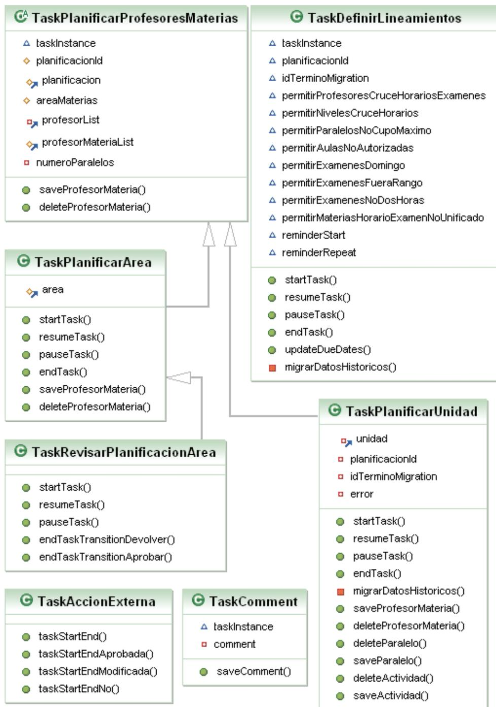
Figura 3.7: Diagrama de clases de las tareas del sistema.
