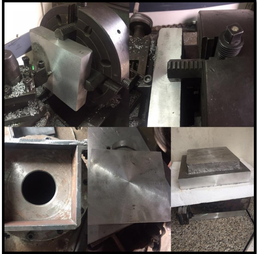
Figura 2. 7 Diseño y fabricación del molde de la baldosa Fuente: Mendoza, J., 2017
