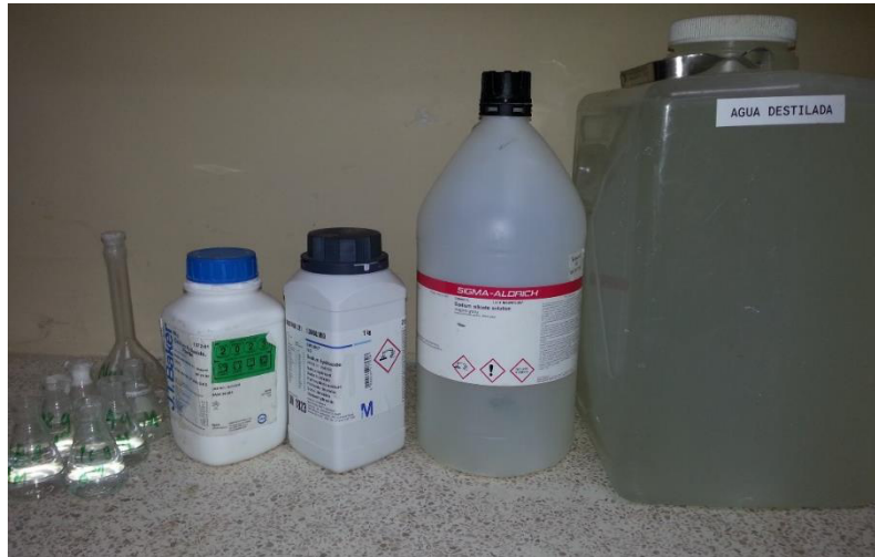
Figura 3.6. Activadores Alcalinos utilizados y matraces volumétricos utilizados.
