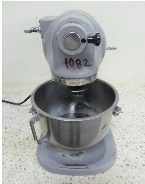
Figura 3.7. Mezclador mecánico HOBART modelo N-50.
