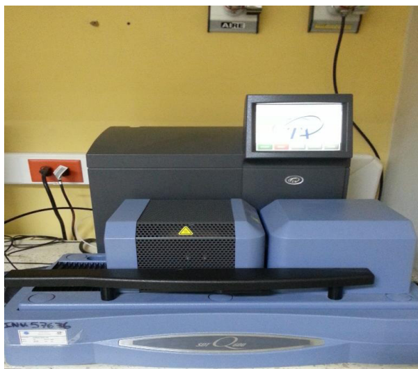
Figura 3.19. Analizador Térmico Simultáneo SDT marca TA® modelo Q600.
