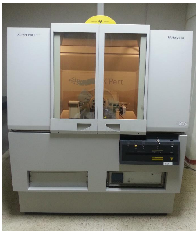
Figura 3.17. Difractómetro de Rayos X marca PANalytical modelo Xpert Data
