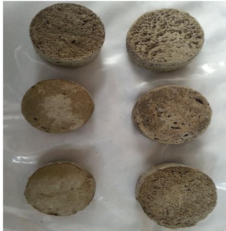
Figura 3.14. Geopolímeros Fomizados después del proceso de curado.
