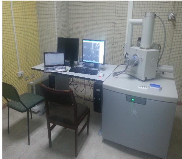
Figura 3.20. Microscopio Electrónico de Barrido (SEM) marca FEI modelo Quantum 200.
