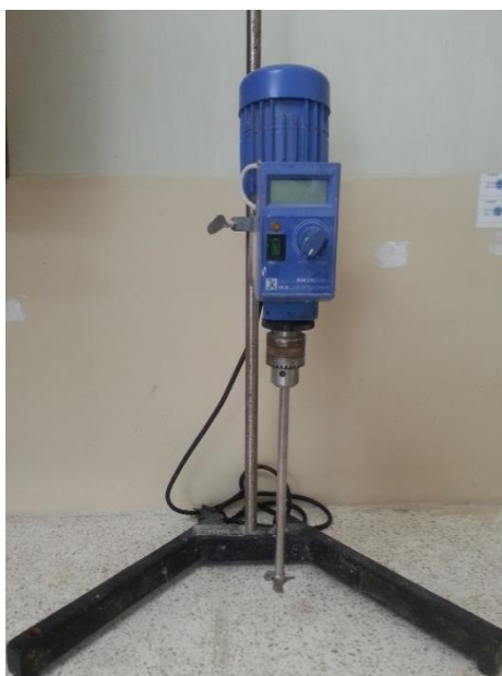
Figura 3.12. Agitador mecánico Ika Labortechnik modelo RW20DZM
