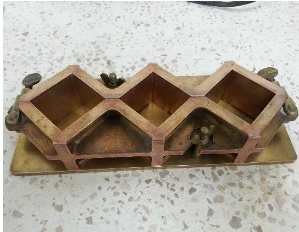
Figura 3.8. Moldes utilizados de acuerdo con la norma ASTM C109/ C109M – 07.
