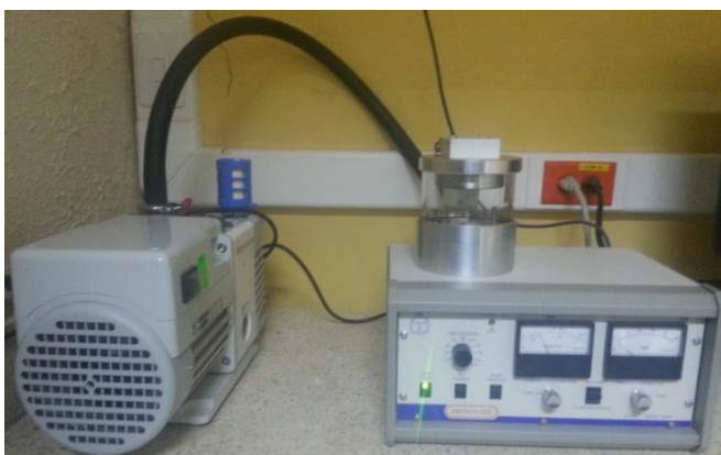
Figura 3.22. Equipo de recubrimiento de platino marca EMITECH.
