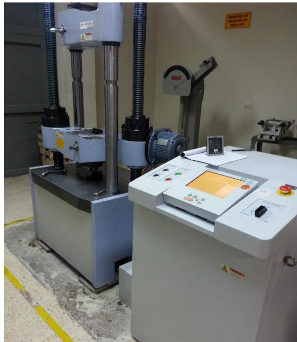
Figura 3.11. Máquina de Ensayos Universales SHIMADZU UTM-600KN
