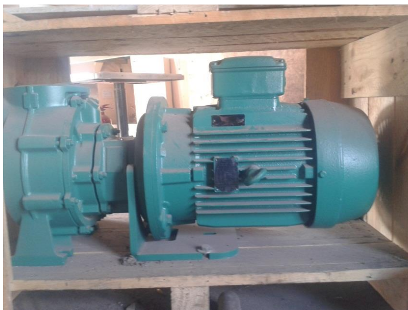
Figura 4. 4: Bomba AZCUE CA80/10A a bordo del B.A.E “Chimborazo”
