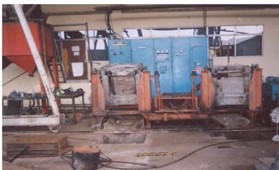
**FIGURA 1.6** Horno inducción a repotenciar
