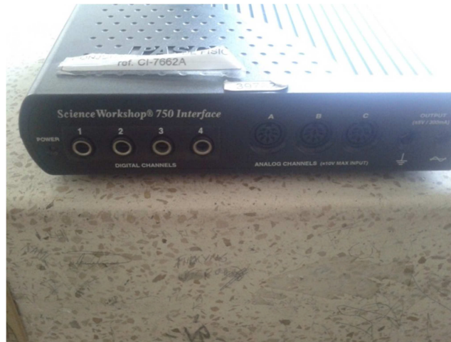
Interfaz para la adquisición de datos y transmitirlos a la computadora
