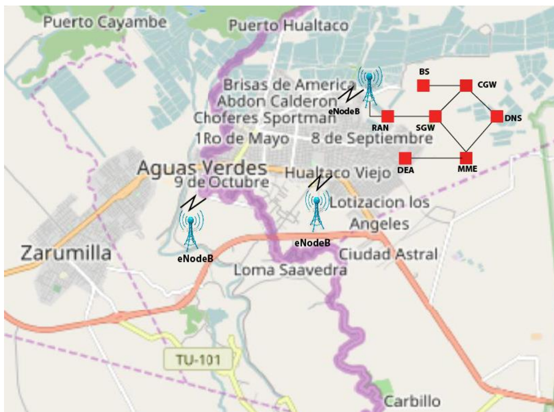
Figura 2.12 Diseño de Red Única de Telecomunicaciones en la frontera Huaquillas (Ecuador)-Aguas Verdes (Perú) [7]
