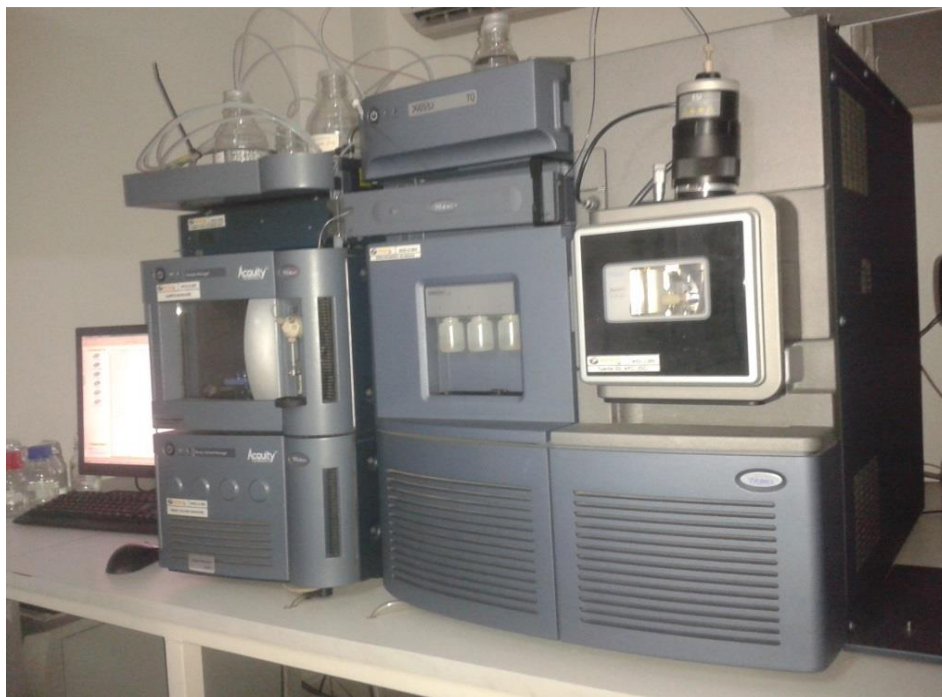
Figura 13. Módulo de separación Acquity BSM acoplado a un espectrómetro de masas XEVO TQ-MS con ionización por electrospray ESI
