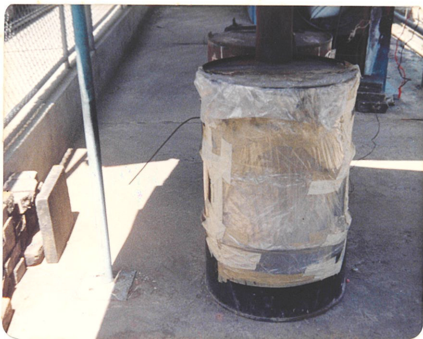
FIG.4.1 FILTRO DE GASES (HORNO OPERANDO CON TIRO NATURAL)
