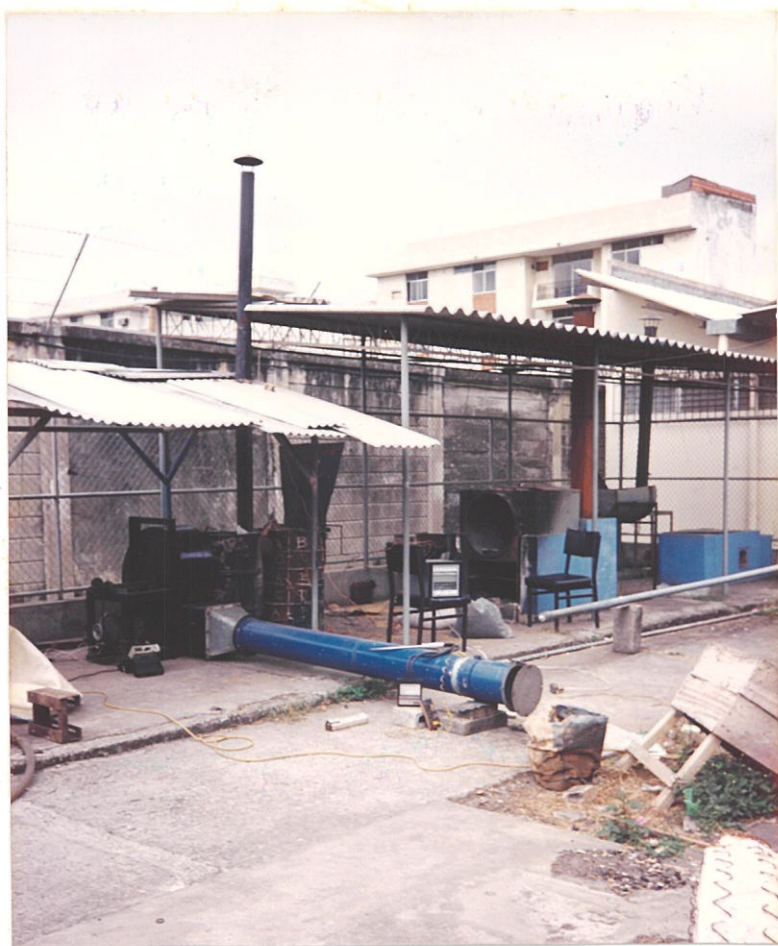
FIG. 4.7 HORNO OPERANDO CON TIRO INDUCIDO Y LA INSTRUMENTACION UTILIZADA
