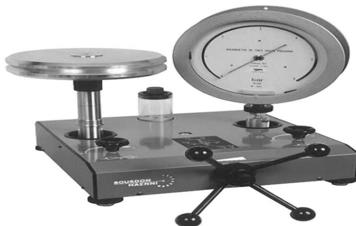
**Figura 2.4: Balanza hidráulica, uso industrial**
