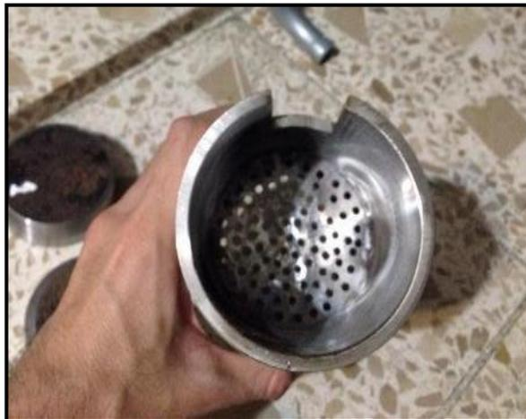
**Figura 2.2: Malla perforada de acero A36**
