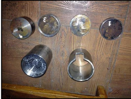
**Figura 2.1: Juego de pesas cilíndricas usados como pistón**
