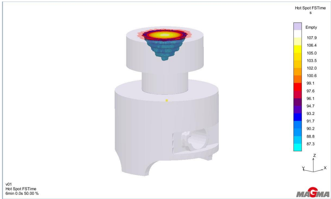
Figura 3.13. Puntos calientes en el sistema de colado.
