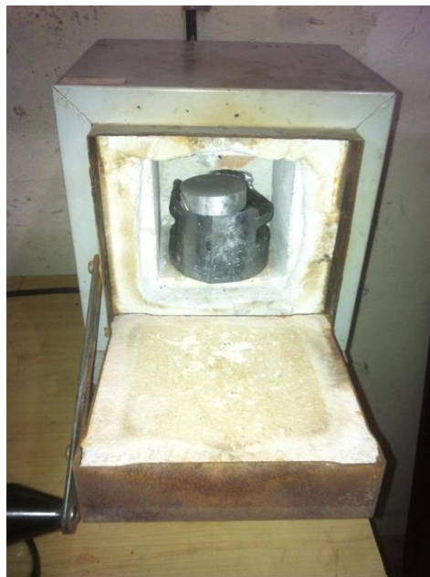
Figura b-7 Tratamiento térmico del pistón
