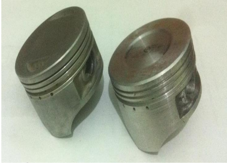
Figura b-14 Pistón final con el pistón original con los orificios de lubricación.
