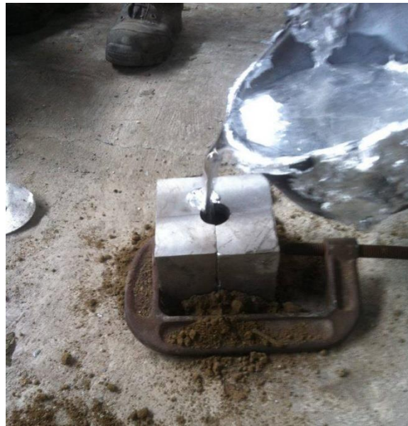
Figura b-6 Vertido de la colada en el molde
