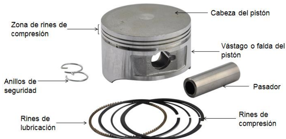
Figura 1.2. Partes principales de un pistón de 4 tiempos.
