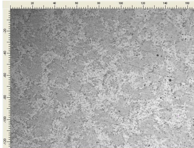
Figura 3.1. Microestructura del pistón original, X100. Ataque con Keller
