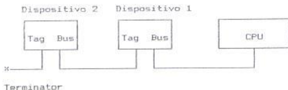
Fig. 4.8. CONEXION DE DISPOSITIVOS EN UN CANAL.
