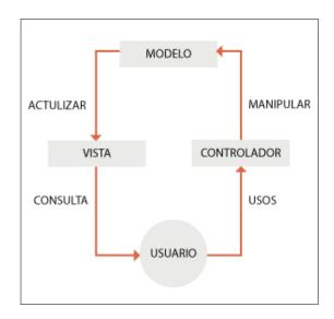
Figura 3.2 Modelo Vista Controlador (MVC)
