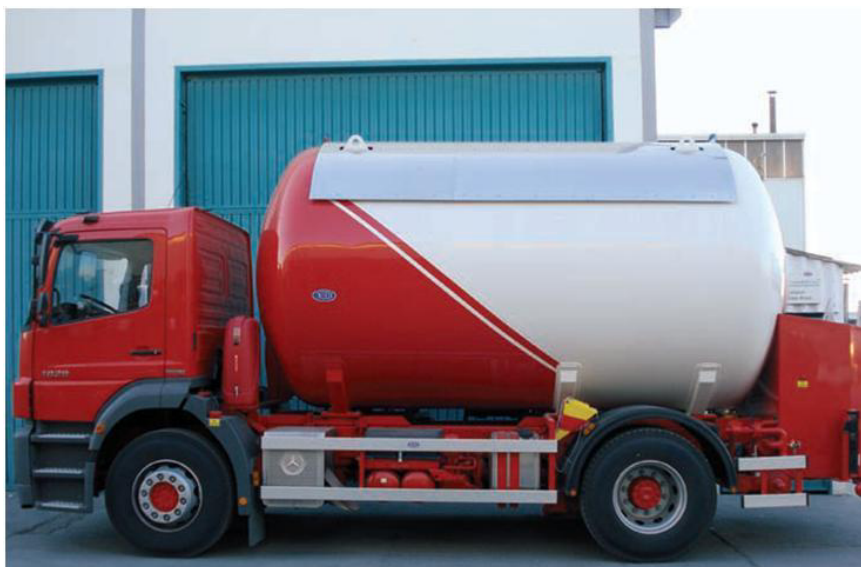
Figura 2.11: Cisterna de Abastecimiento de GLP
